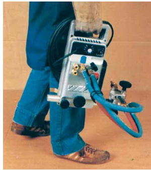
2. proFIT für automatische Gerad-schnitte durch Winkelprofilführung
