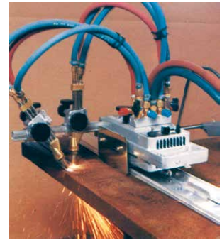
4. Die proFIT ist aufgrund eines Leichtmetallgehäuses bequem tragbar
